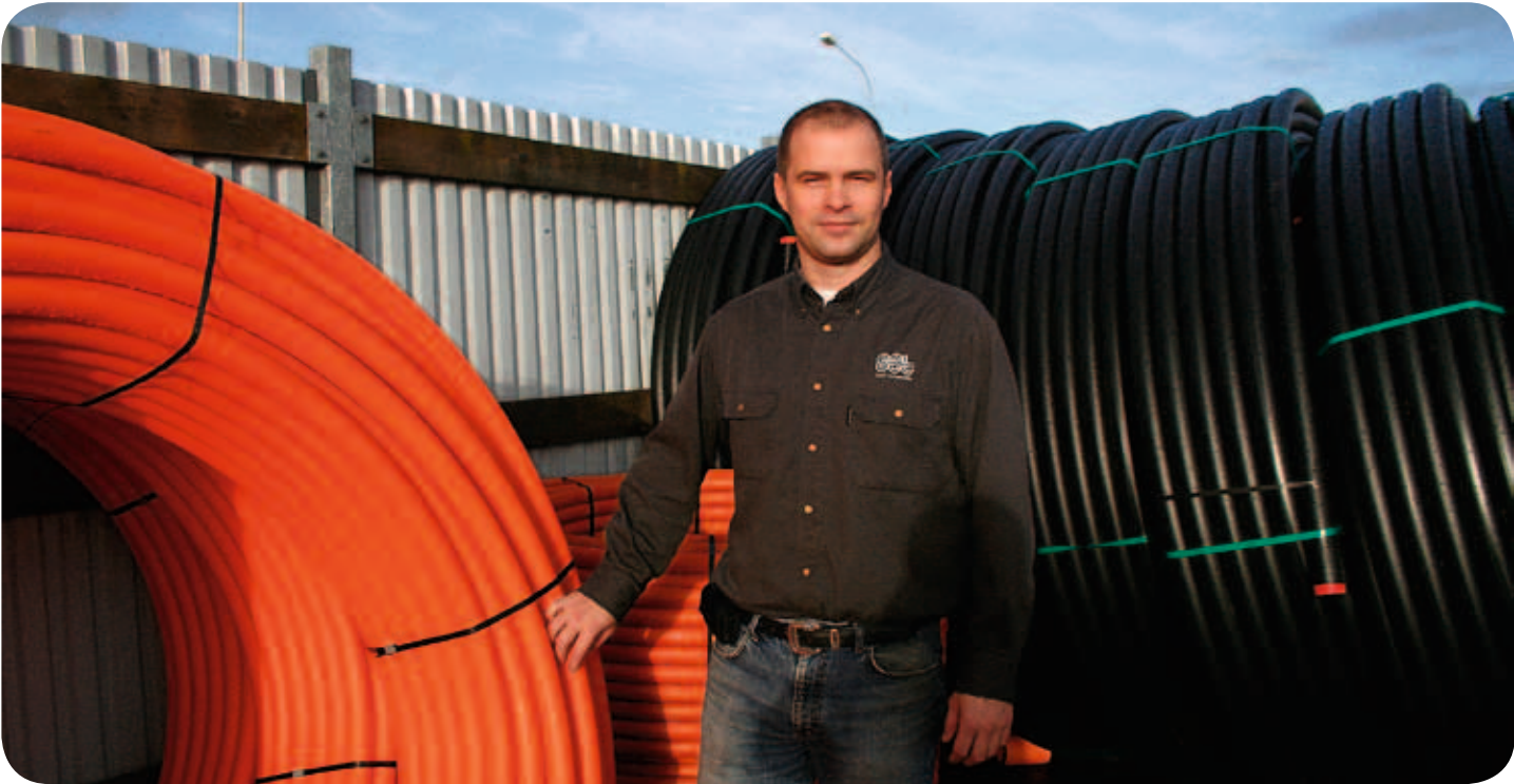
Róbert Karel Guðnason, vinnslustjóri í plaströradeild Sets ehf. á Selfossi, við hlífðarrör fyrir ljósleiðaralagnir en nú er unnið að tilraunum með rör sem eru riffluð að innan en það léttir ídrátt og þræðingu.
